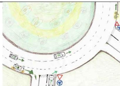
**Среднее кольцо** – диаметр от 32 до 24 метров; имеет только одну полосу движения (иногда 2 полосы). Данный тип кольца является более безопасным, согласно статистическим данным, и менее аварийным по сравнению с другими типами кольцевого движения. Позволяет также движение автопоездов (длиной до 18,75 метров).
