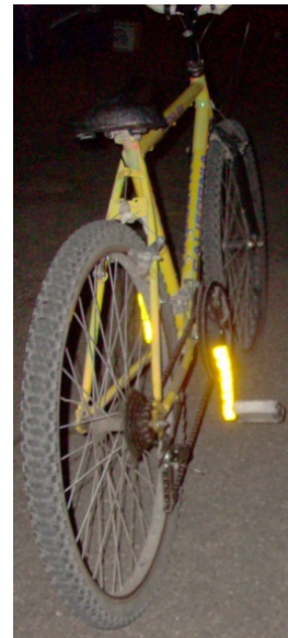
Figura 4.9 Bicicletta sperimentale al buio: si notano le pedivelle retroriflettoni
