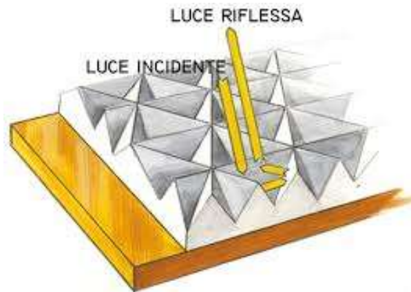
Figura 2.2 Meccanismo di luce incidente e luce riflessa
